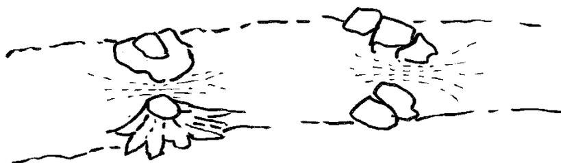
Abb. 1: Schlitzrampen mit Strömungsbündelung
